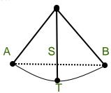
Die durchgezogenen Linien sind der Kugelradius, die gestrichelte Linie der Durchmesser des Segments. Die Strecke [ST] hat die Länge h und somit die Strecke [MS] die Länge r – h.
